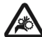
Pericolo di trascinamento
